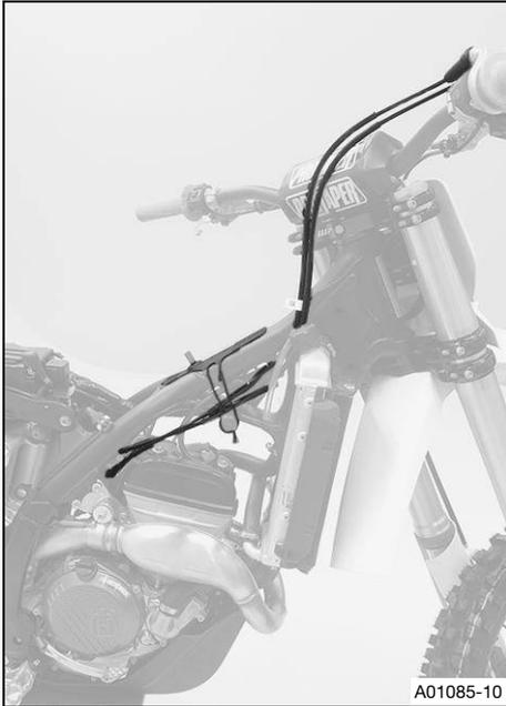
Beide Gasbowdenzüge müssen nebeneinander an der Hinterseite des Lenkers, oberhalb der Kraftstofftankrolle, zum Drosselklappenkörper verlegt sein. Beide Gasbowdenzüge müssen hinter dem Haltegummi der Kraftstofftank-Auflage gesichert sein.
