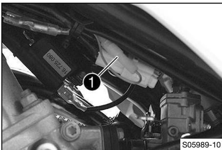
El conector **1** para el reajuste de la curva de encendido se encuentra en el chasis, debajo del depósito de combustible.
