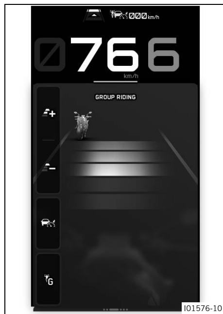
Modalità del Cruise Control Adattivo pensata appositamente per la guida in grossi gruppi di moto. Il rilevamento di oggetti rilevanti passa dal veicolo che precede all'oggetto più vicino con spostamento laterale. La funzione si basa sul veicolo più vicino con spostamento laterale, non sull'oggetto che precede direttamente. La distanza dall'oggetto rilevato può essere impostata su 5 livelli, da molto breve a molto lunga.
