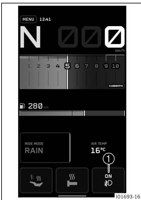
Lo stato delle luci supplementari viene visualizzato nel campo 1 del display.
