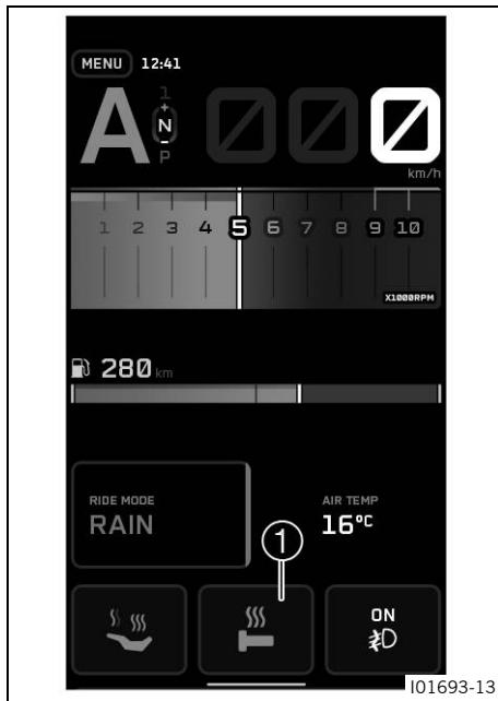
Lo stato del riscaldamento delle manopole viene visualizzato nel campo 1 del display.
