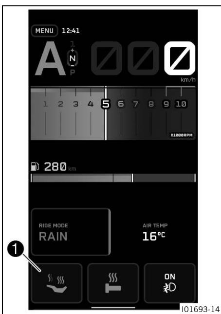
Lo stato del riscaldamento della sella viene visualizzato nel campo 1 del display.
