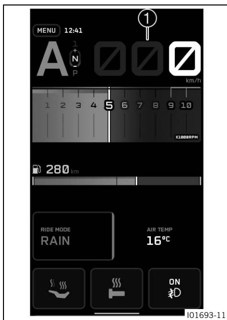
La velocità viene visualizzata nel campo 1 del display. L'unità di misura della velocità può essere configurata nel menu **Units**. La velocità viene visualizzata in chilometri orari **km/h** o in miglia orarie **mph**.
