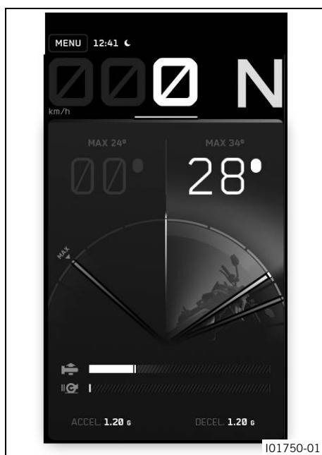
Nel display **Telemetry** vengono visualizzati ad esempio l'angolo di piega, l'accelerazione e la posizione della manopola dell'acceleratore.
