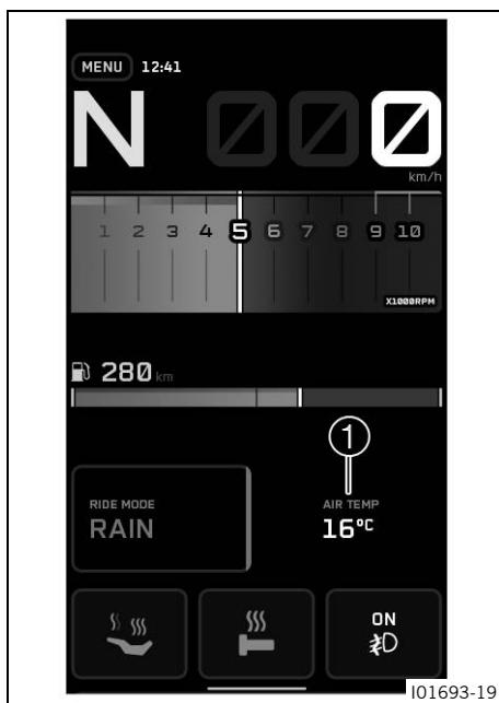
La temperatura dell'aria ambiente viene visualizzata nell'area 1 del display.
