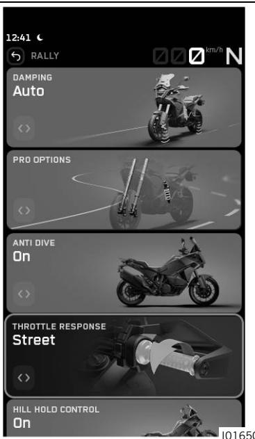
Nel quadro strumenti, attraverso il sottomenu **Throttle Response**, è possibile adattare la curva caratteristica della risposta dell'acceleratore.
