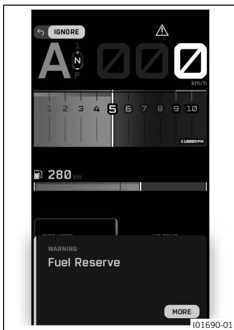
Le avvertenze vengono visualizzate nella parte inferiore del display e, a seconda dell'importanza, sono di colore giallo o rosso.
