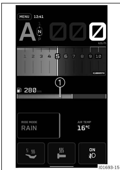
La capacità del serbatoio viene visualizzata nel campo ① del display.
