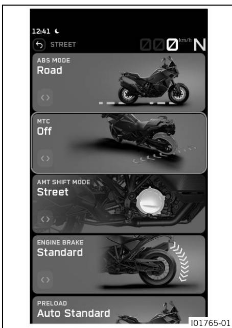
In caso di perdita di trazione della ruota posteriore, il controllo della trazione della motocicletta (**MTC**) riduce la coppia del motore. A seconda della modalità di marcia (Pag. 207) varia la misura di slittamento consentita con controllo trazione attivato.
