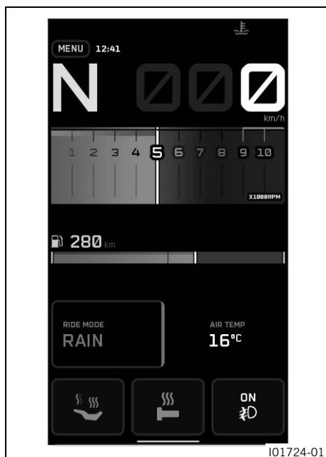
La temperatura del liquido di raffreddamento viene visualizzata con un'icona . Il colore del simbolo cambia a seconda della temperatura. Quando il motore è a temperatura di esercizio, il simbolo scompare.
