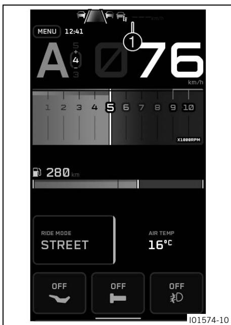
Lo stato operativo e la velocità impostata dell'Adaptive Cruise Control attivato sono visualizzati nel campo ① del display.
