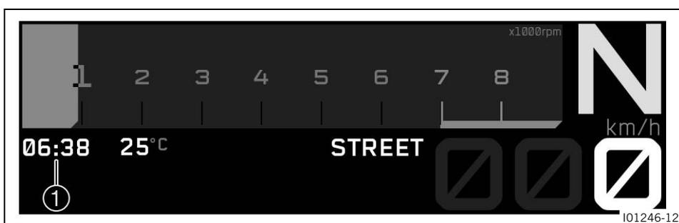
Die Uhrzeit wird im Bereich **1** des Displays angezeigt. In allen Sprachen kann die Uhrzeit im 24-Stunden-Format oder 12-Stunden-Format angezeigt werden. Das Format der Uhrzeit kann im Menü **Clock Format** konfiguriert werden.
