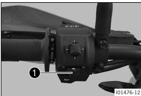
Der Blinkerschalter 1 ist am Lenker links angebracht. Zum Ausschalten des Blinkers den Blinkerschalter zum Schaltergehäuse drücken.
