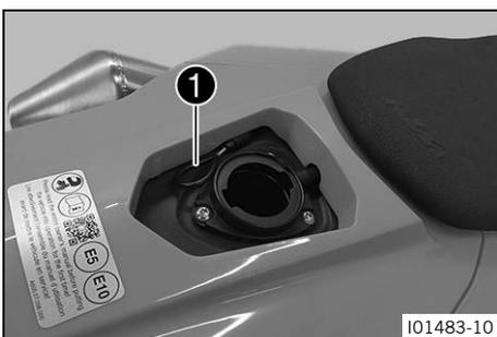
Die Schlaufe **1** zum Entriegeln der Sitzbank befindet sich unter dem Kraftstofftankverschluss.
