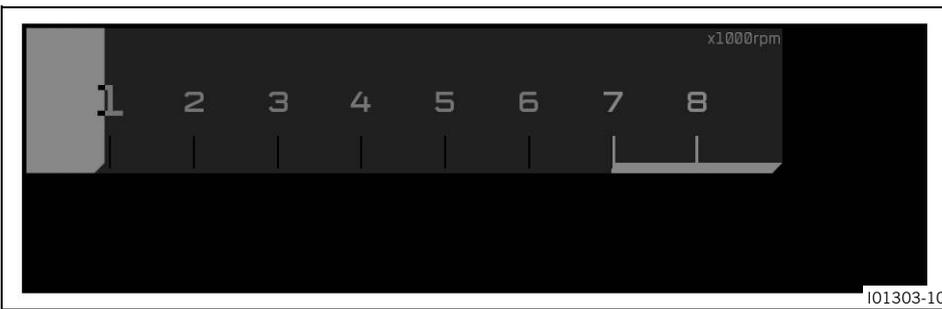
Die Drehzahl wird in Umdrehungen pro Minute angezeigt.
