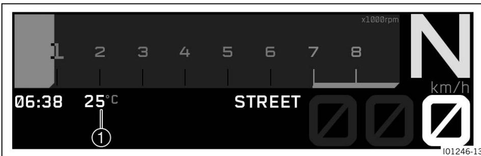
Die Umgebungslufttemperatur wird im Bereich **1** des Displays angezeigt.
