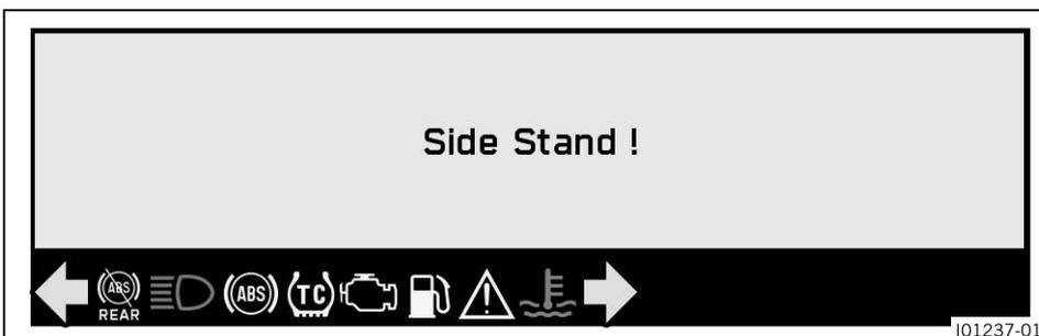
Warnungen erscheinen in der Mitte des Displays, je nach Relevanz werden diese gelb oder rot hinterlegt. Gelbe Warnungen zeigen eine Fehlfunktion oder Informationen, die zeitnahes Eingreifen oder Anpassung der Fahrweise erfordern.
