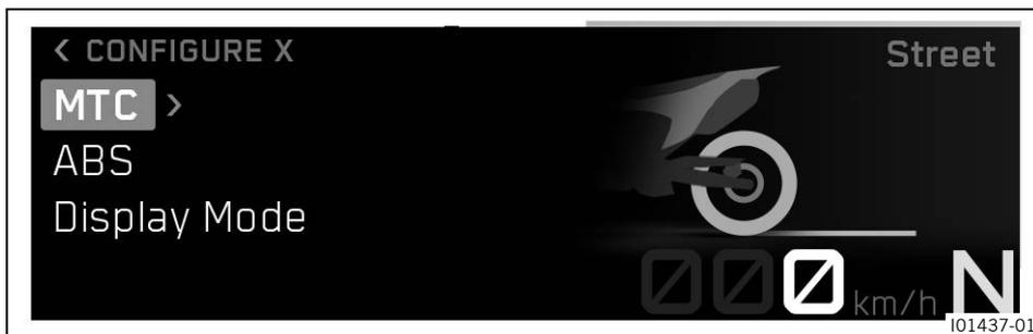
Im Kombiinstrument kann über das Untermenü **MTC** die Motorrad-Traktionskontrolle ein- oder ausgeschaltet werden.
