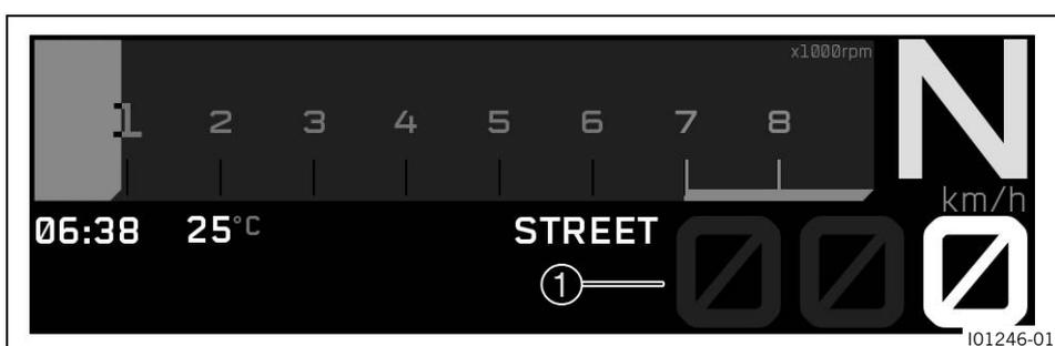
Die Geschwindigkeit wird im Bereich ① des Displays angezeigt.
