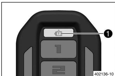
Die Fehlfunktionen werden über die Fehlfunktion-Kontrollleuchte **1** angezeigt und synchron über Töne ausgegeben.
