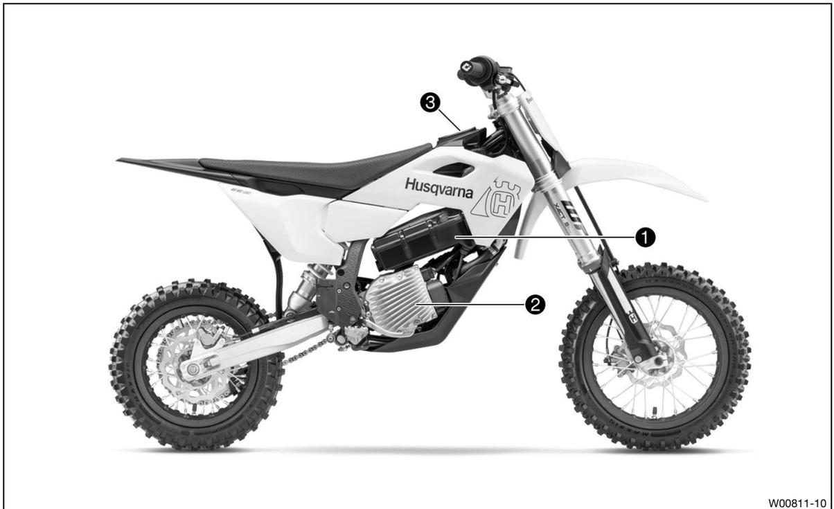
Im Fahrzeug ist ein Lithium-Ionen-Akkumulator ❶ (LV-Traktionsbatterie) verbaut. Die LV-Traktionsbatterie versorgt den Elektromotor ❷ und das Multifunktionselement ❸ mit Spannung. Die LV-Traktionsbatterie ist fest mit Rahmen und Motor verschraubt.
