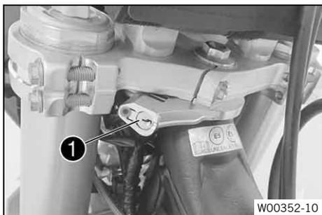
Das Lenkschloss **1** ist am Steuerkopf links angebracht. Durch das Lenkschloss kann die Lenkung gesperrt werden. Ein Lenken und damit Fahren ist nicht mehr möglich.
