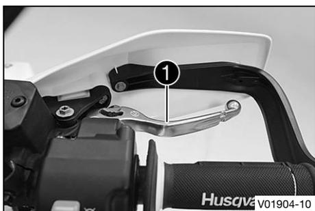
Der Handbremshebel **1** ist am Lenker rechts angebracht. Mit dem Handbremshebel wird die Vorderradbremse betätigt.
