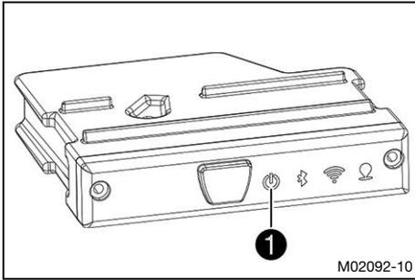
Las anomalías de funcionamiento se indican mediante el parpadeo en rojo del testigo de control ❶.
