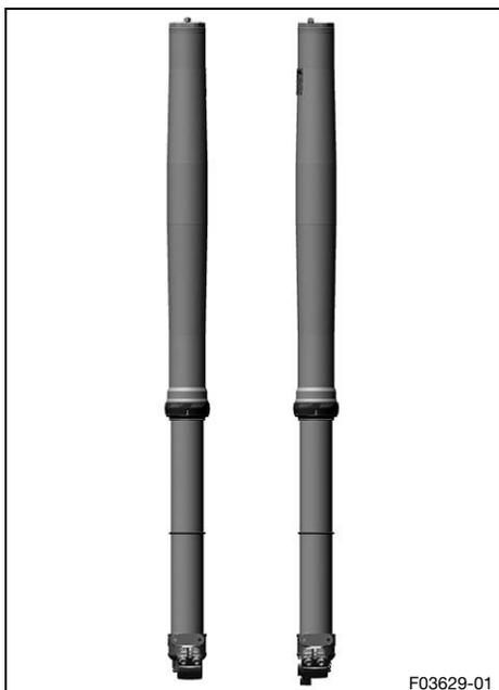
En la horquilla **WP XACT** se utiliza una suspensión neumática. En este sistema, la suspensión se encuentra en la botella izquierda de la horquilla y la amortiguación en la botella derecha de la horquilla.
