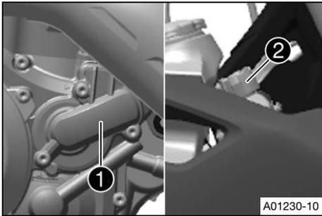
La bomba del agua ❶ en el motor asegura una circulación forzada del líquido refrigerante.
