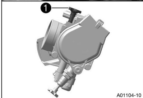
La posición de ralentí en el cuerpo de la válvula de mariposa influye considerablemente en la capacidad de arranque del motor, la estabilidad del régimen de ralentí y la respuesta al acelerar.
