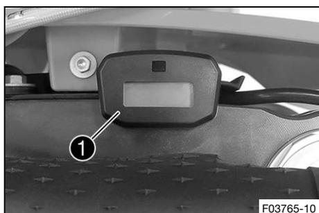
El cuadro de instrumentos **1** se encuentra delante del manillar. El cuadro de instrumentos indica las horas de servicio totales del motor.
