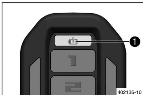
Las anomalías de funcionamiento se señalizan mediante el testigo de control de anomalía de funcionamiento ❶ y tonos acústicos simultáneos.
