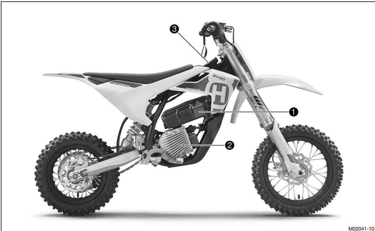
El vehículo incorpora un acumulador de iones de litio **1** (batería de tracción LV). La batería de tracción LV suministra tensión al motor eléctrico **2** y al elemento multifuncional **3**. La batería de tracción LV está firmemente atornillada al chasis y al motor.
