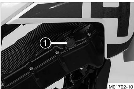
El botón de encendido/apagado ❶ se encuentra en el lado derecho de la batería de tracción LV.
