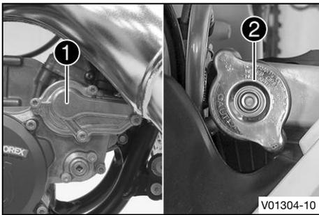
La bomba del agua ① en el motor asegura una circulación forzada del líquido refrigerante.
