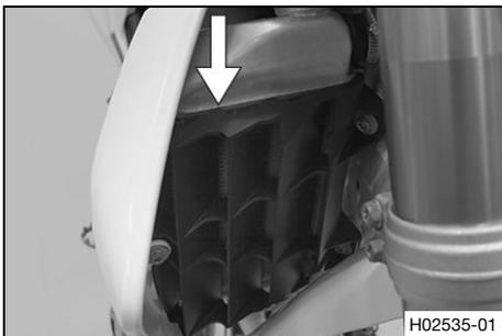
Las cubiertas del radiador se montan delante del radiador, entre la protección del radiador y el radiador.
