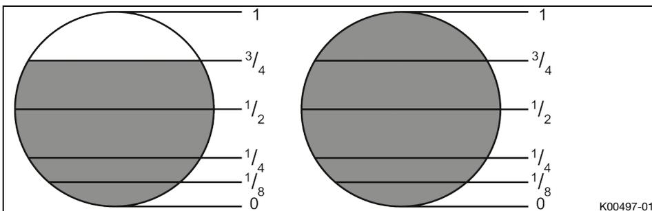
Cuando la corredera del gas está abierta 3/4, tiene el mayor efecto el chiclé principal. La posición del clip y el chiclé de ralentí tienen un efecto muy reducido.
