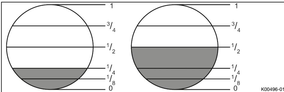
Cuando la corredera del gas está abierta 1/4, tienen el mayor efecto el chiclé de ralentí y la posición del clip. La primera parte cilíndrica de la aguja tiene un efecto muy reducido.
