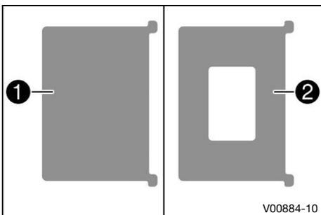
Las cubiertas del radiador se montan delante del radiador en función de la temperatura ambiente.
