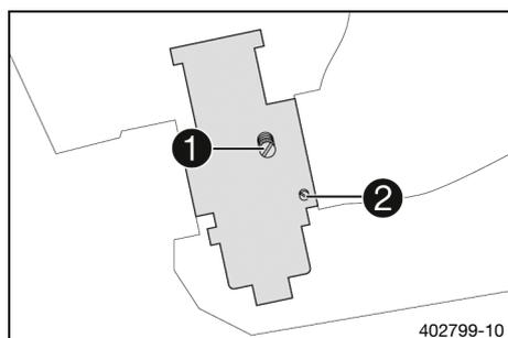
La posición de ralentí del carburador influye mucho en la respuesta de arranque del motor, un régimen de ralentí estable y la respuesta al acelerar. Esto significa que un motor con un régimen de ralentí ajustado correctamente arrancará más fácilmente que uno con un régimen mal ajustado.
