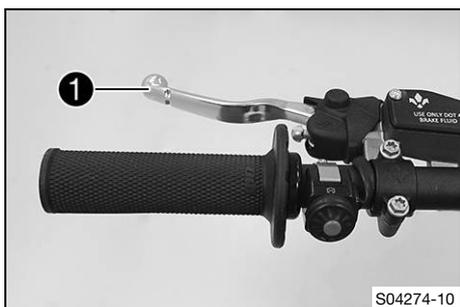
La maneta del embrague ❶ se encuentra en el lado izquierdo del manillar. El embrague se acciona por vía hidráulica, y se reajusta automáticamente.
