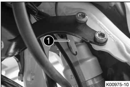
El conector ❶ para el reajuste de la curva de encendido se encuentra en el chasis, debajo del depósito de combustible.
