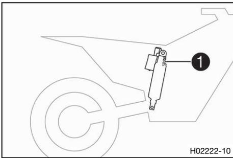
La referencia del amortiguador **1** está grabada en la parte superior del amortiguador, por encima del anillo de ajuste, mirando hacia el motor.
