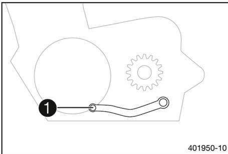
El pedal de cambio ❶ está montado a la izquierda del motor.
