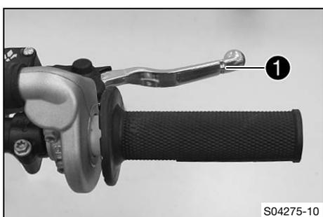
La maneta del freno de mano ❶ se encuentra en el lado derecho del manillar. La maneta del freno de mano permite accionar el freno de la rueda delantera.
