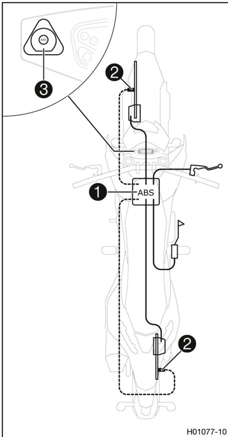
El módulo del ABS ①, compuesto por una unidad hidráulica, una centralita electrónica del ABS y una bomba de recirculación, está instalado debajo del asiento. Hay un sensor de número de revoluciones de la rueda ② tanto en la rueda delantera como en la trasera.
