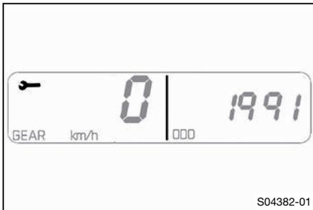
Die Serviceanzeige befindet sich oben links im Display.
