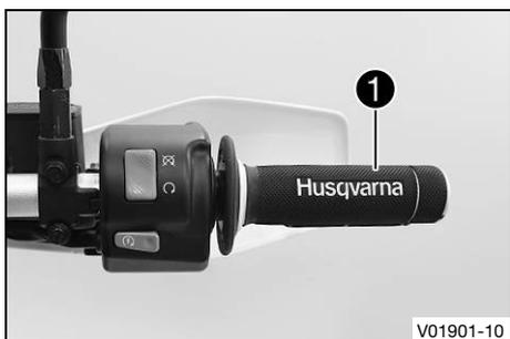
Der Gasdrehgriff **1** ist am Lenker rechts angebracht.
