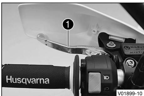
Der Kupplungshebel **1** ist am Lenker links angebracht. Die Kupplung wird hydraulisch betätigt und stellt sich automatisch nach.
