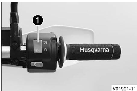
Der Not-Aus-Schalter ❶ ist am Lenker rechts angebracht.
