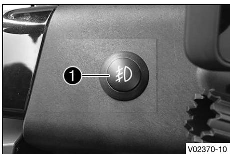
Le bouton des phares additionnels ❶ est situé à gauche à côté du tableau de bord.
