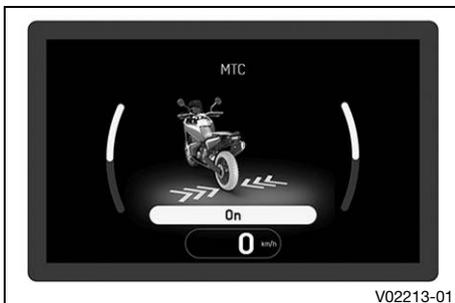
Le contrôle de la traction de la moto (MTC) réduit le couple du moteur en cas de perte de traction de la roue arrière. Selon le mode de conduite (p. 142), différents niveaux de perte d'adhérence sont autorisés lorsque le contrôle de la traction est activé.
