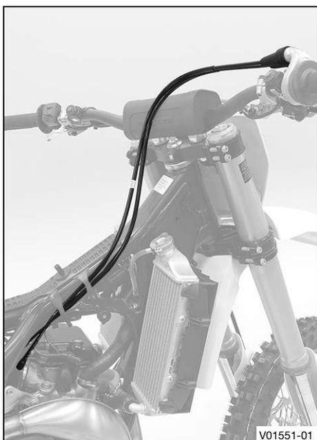
Los dos cables bowden del gas deben pasar juntos por la parte posterior del manillar, por encima del soporte del depósito de combustible, hacia el cuerpo de la válvula de mariposa. Los dos cables bowden del gas deben estar asegurados detrás de la goma de sujeción del soporte del depósito de combustible.
