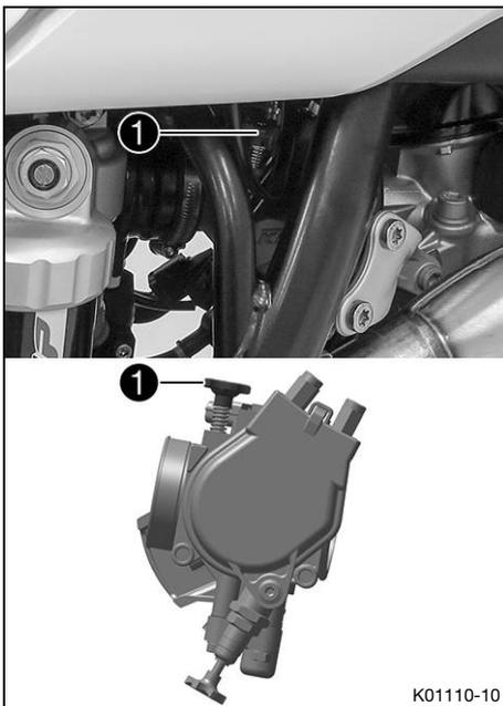
La posición de ralentí en el cuerpo de la válvula de mariposa influye considerablemente en la capacidad de arranque del motor, la estabilidad del régimen de ralentí y la respuesta al acelerar.
