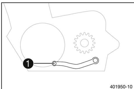
El pedal de cambio **1** está montado a la izquierda del motor.
