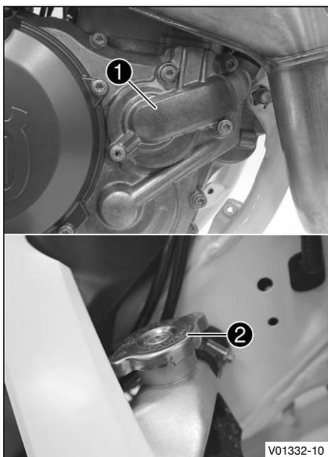
La bomba del agua ① en el motor asegura una circulación forzada del líquido refrigerante.
