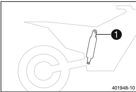
El número de artículo del amortiguador ❶ está grabado en la parte superior del amortiguador, por encima del anillo de ajuste, mirando hacia el motor.
