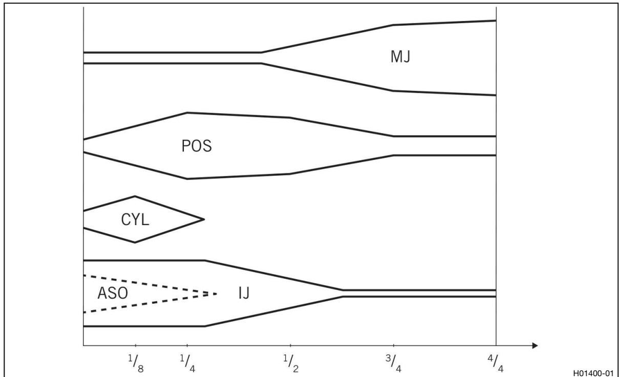
Los diferentes componentes del carburador deben adecuarse entre sí y al uso previsto.
