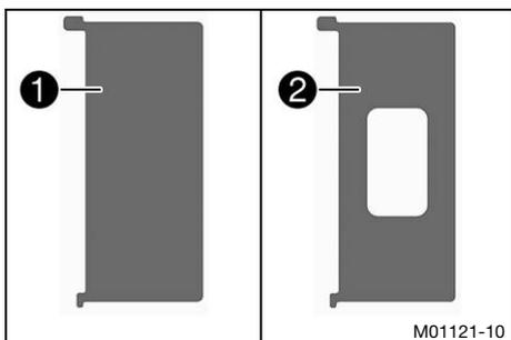
La cubierta del radiador se monta delante del radiador izquierdo en función de la temperatura ambiente.
