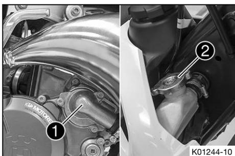
La bomba de agua **1** del motor hace circular de manera forzada el líquido refrigerante. La presión que se genera en el sistema de refrigeración con el calentamiento se regula por medio de una válvula situada en el tapón del radiador **2**. De esta manera, el refrigerante puede alcanzar la temperatura especificada sin provocar ningún problema de funcionamiento.
