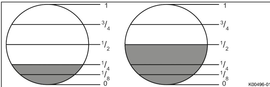
Cuando la corredera del gas está abierta 1/4, tienen el mayor efecto el chiclé de ralentí y la posición del clip. La primera parte cilíndrica de la aguja tiene un efecto muy reducido. Cuando la corredera del gas está abierta 1/2, tiene el mayor efecto la posición de la aguja. El chiclé principal y el chiclé de ralentí tienen un efecto muy reducido.
