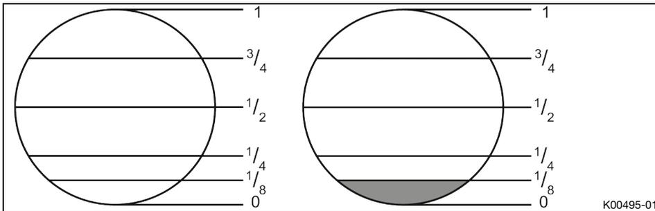
El máximo efecto de la corredera del gas tiene lugar cuando la corredera del gas está cerrada. La primera parte cilíndrica de la aguja y la posición del clip tienen un efecto muy reducido. Cuando la corredera del gas está abierta 1/8, tienen el mayor efecto la primera parte cilíndrica de la aguja, el chiclé de ralentí y la posición del clip.
