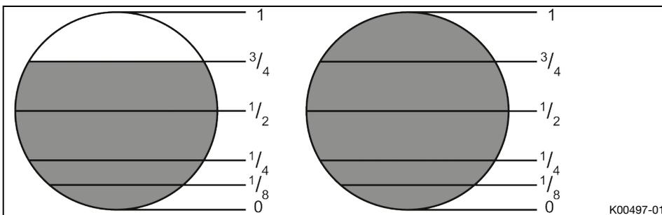
Cuando la corredera del gas está abierta 3/4, tiene el mayor efecto el chiclé principal. La posición del clip y el chiclé de ralentí tienen un efecto muy reducido.
