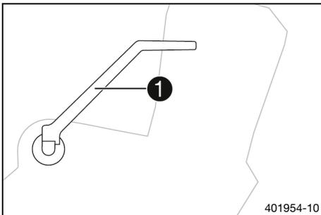
La palanca del pedal de arranque ❶ se encuentra en el lado derecho del motor. La palanca del pedal de arranque puede girar.
