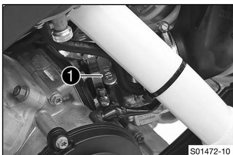
La palanca de arranque en frío ① se encuentra en el lado izquierdo del carburador.
