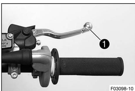
La maneta del freno de mano **1** se encuentra en el lado derecho del manillar. La maneta del freno de mano acciona el freno delantero.
