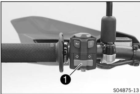
Der Blinkerschalter ① ist am Lenker links angebracht.
