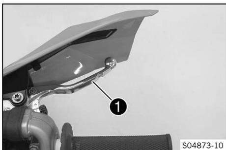
Der Handbremshebel ❶ ist am Lenker rechts angebracht. Mit dem Handbremshebel wird die Vorderradbremse betätigt.
