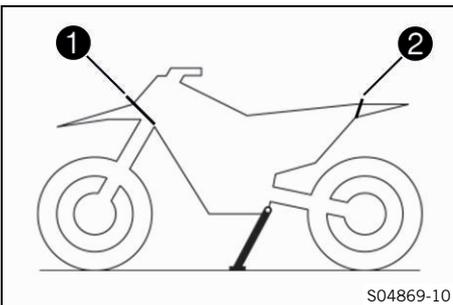
Die Halteriemen befinden sich am Fahrzeug vorn **1** und hinten **2**.
