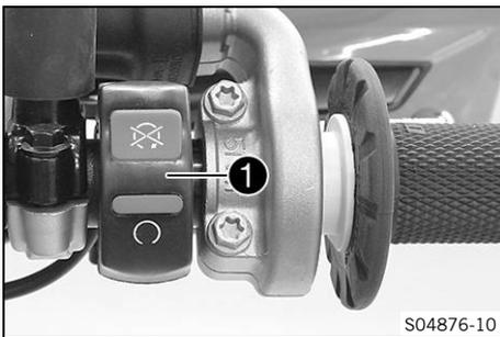
Der Not-Aus-Schalter ① ist am Lenker rechts angebracht.
