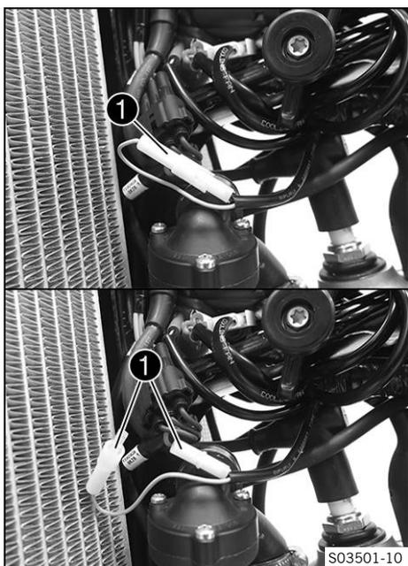
Die Steckerverbindung ❶ der Zündkurvenanpassung befindet sich unter dem Kraftstofftank am Rahmen.
