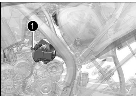
Der Kaltstartknopf **1** ist am Drosselklappenkörper seitlich angebracht.
