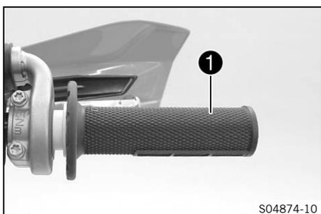
Der Gasdrehgriff ❶ ist am Lenker rechts angebracht.
