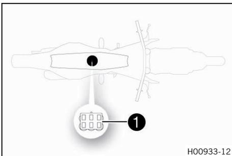
Der Diagnosestecker ① befindet sich unter der Sitzbank unterhalb des EFI-Steuergeräts.
