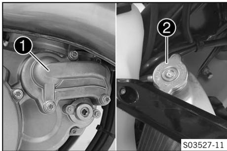
Durch die Wasserpumpe ① im Motor ist ein Zwangsumlauf der Kühlflüssigkeit gegeben. Der bei Erwärmung entstehende Druck im Kühlsystem wird durch ein Ventil im Kühlerschluss ② geregelt. Dadurch ist die angegebene Kühlflüssigkeitstemperatur zulässig, ohne dass mit Funktionsstörungen zu rechnen ist.
