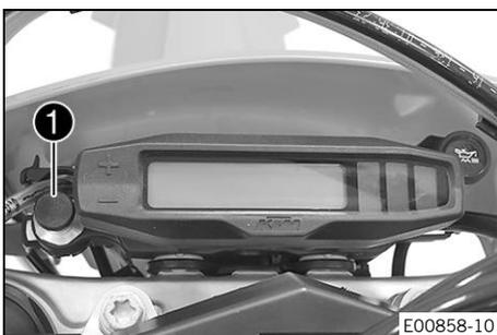
Der Lichtschalter ❶ befindet sich links neben dem Kombiinstrument.
