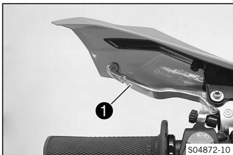
Der Kupplungshebel ❶ ist am Lenker links angebracht. Die Kupplung wird hydraulisch betätigt und stellt sich automatisch nach.
