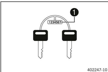
Die Schlüsselnummer ❶ für das Lenkschloss ist am Schlüsselverbinder eingepägt.
