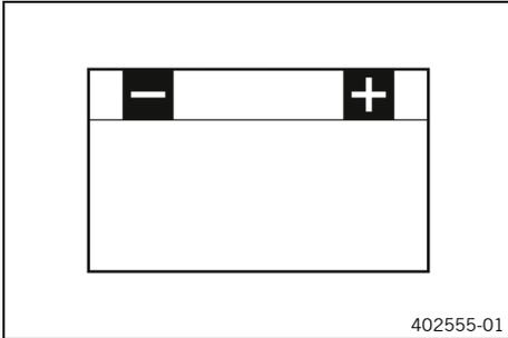
Lithium-Ionen-Batterien sind wesentlich leichter als Bleibatterien, haben eine geringe Selbstentladung und bei Temperaturen über 15 °C (60 °F) mehr Startleistung. Die Startleistung von Lithium-Ionen-Batterien verringert sich jedoch bei niedrigen Temperaturen mehr als bei Bleibatterien.
