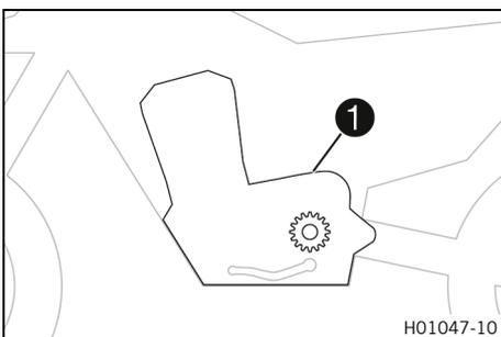
Die Motornummer ❶ ist an der linken Motorseite oberhalb des Kettenritzels eingepägt.
