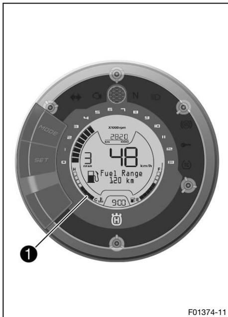
La temperatura del líquido refrigerante se muestra en la zona **1** del display.
