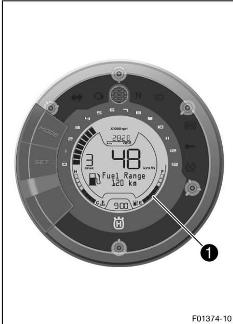
La capacidad del depósito de combustible se muestra en la zona **1** del display.
