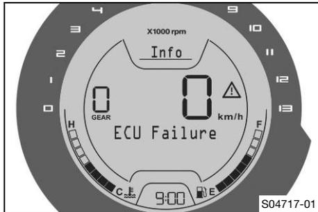
**ECU Failure** aparece en el display cuando la unidad de mando del motor emite un fallo.
