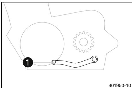
El pedal de cambio ❶ está instalado a la izquierda del motor.
