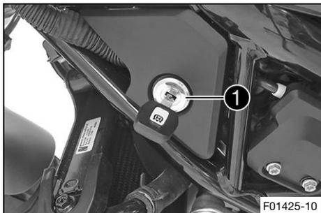
El cierre del asiento **1** se encuentra en la parte delantera izquierda debajo del depósito de combustible. El cierre del asiento se puede desbloquear con la llave de encendido.
