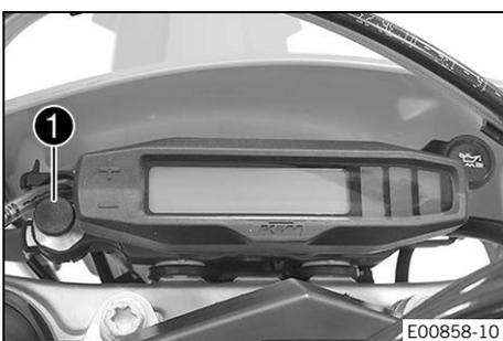
O interruptor da luz ❶ encontra-se do lado esquerdo, junto do instrumento combinado.
