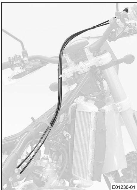
2本のアクセルワイヤーが揃って、ハンドルバーの後ろからフレーム右のフューエルタンク取付け部の上を通り、スロットルバルブ本体に取り回されている事を確認して下さい。アクセルワイヤーは両方ともフューエルタンク取付け部分のゴムバンドの後ろに取り回されている事を確認して下さい。
