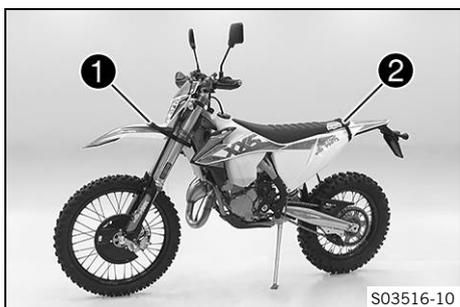
Las correas de sujeción están situadas en la parte delantera **1** y trasera **2** del vehículo.
