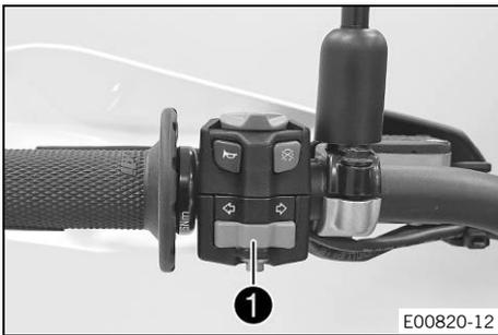
Der Blinkerschalter ❶ ist am Lenker links angebracht.
