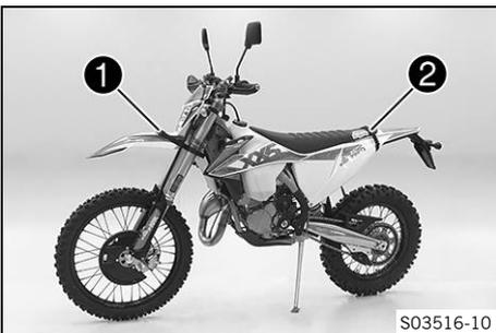
Die Haltegurte befinden sich am Fahrzeug vorn ① und hinten ②.
