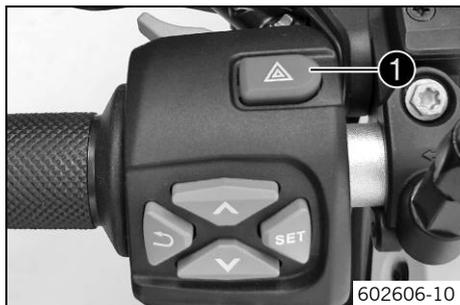
Der Warnblinkschalter ① ist am Kombischalter links angebracht.
