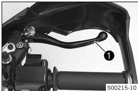
Der Handbremshebel ❶ ist am Lenker rechts angebracht.
