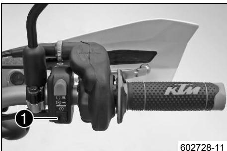
Gumb električnega zaganjalnika (1) je nameščen desno na krmilu.
