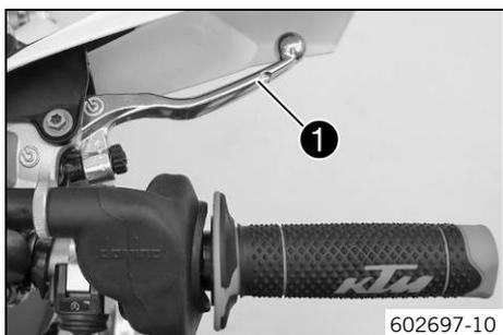
A alavanca do travão de mão ❶ está colocada no lado direito do guiador. Com a alavanca do travão de mão aciona-se o travão da roda dianteira.
