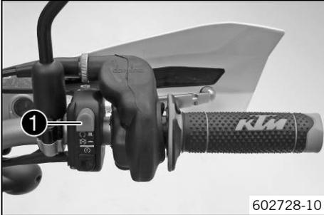
O interruptor de paragem de emergência **1** está colocado no guiador do lado direito.
