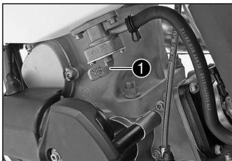
Il rubinetto si trova in corrispondenza del lato sinistro del serbatoio del carburante. La manopola **1** del rubinetto del carburante permette di aprire e chiudere l'alimentazione del carburante verso il carburatore.
