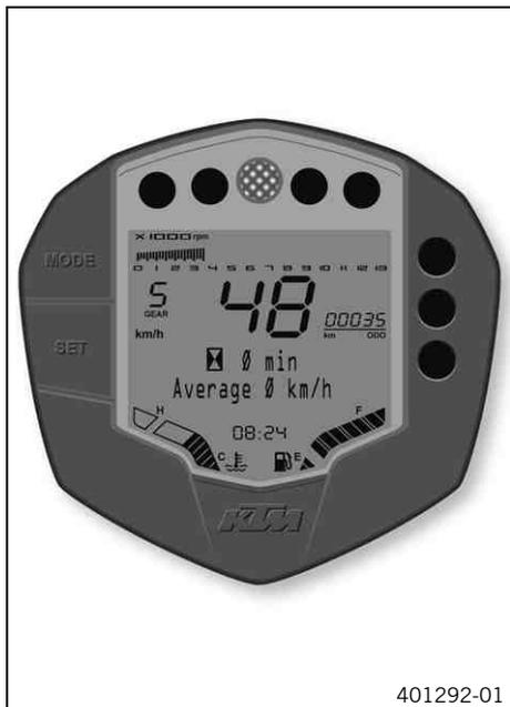
L'indicatore di livello del display è composto da 9 barre. Più barre sono accese, maggiore è la quantità di carburante presente nel serbatoio.
